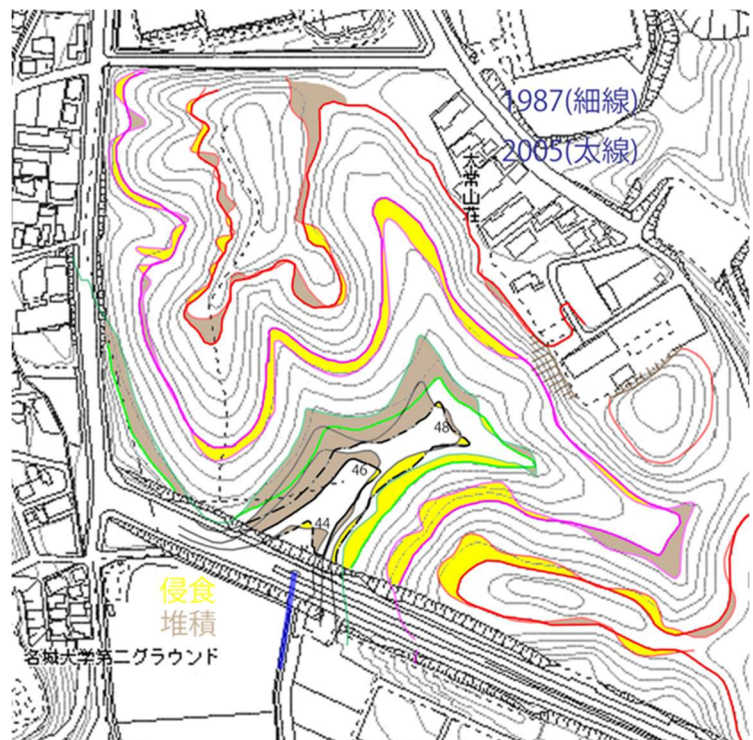
図4 等高線の高度変化と侵食・堆積の推定
